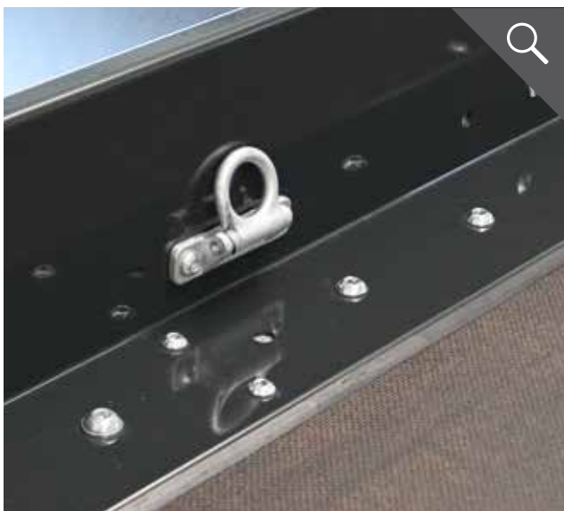
8 - 10 abklappbare Zurrösen mit bis zu 400 daN Zugkraft
