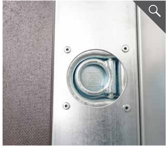
Zurrmulden versenkt im Bodenrahmenprofil, Dekra zertifiziert
