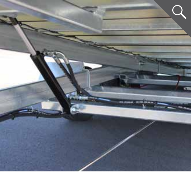
Doppeltwirkende Hydraulikzylinder für sicheres Beladen
