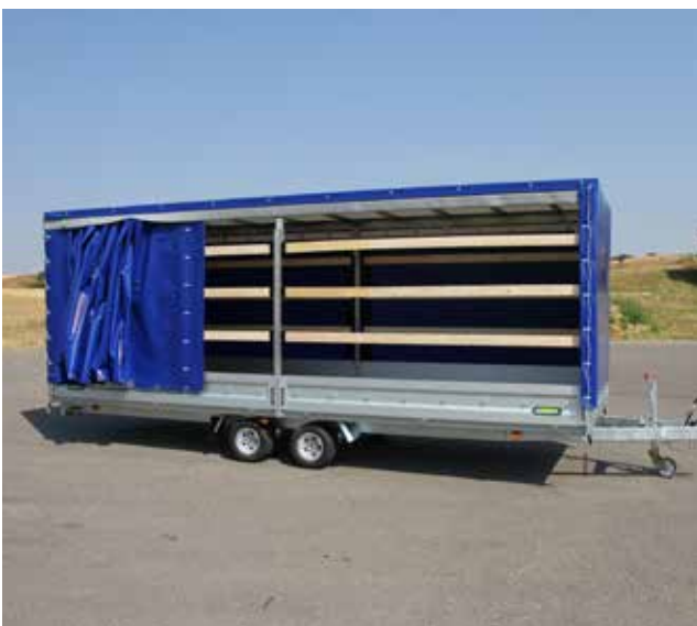
Planenaufbau mit Schiebeplane in blau RAL 5002
