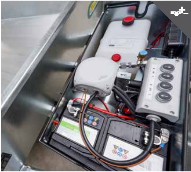
Leistungsstarke Elektrohydraulik wasser- und schmutzgeschützt
