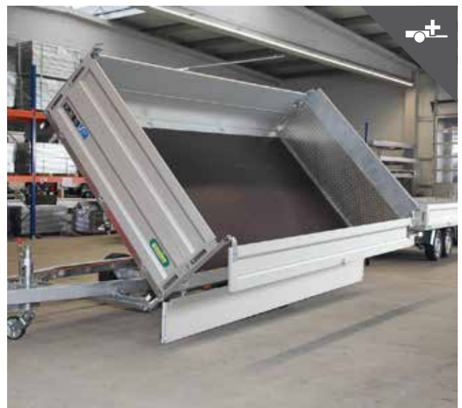
Bordwandaufsatz für mehr Ladevolumen
