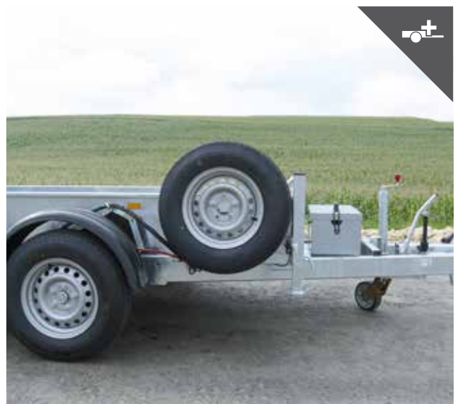
Ersatzradhalter für Bordwandmontage
