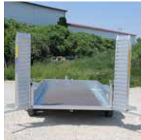
Auffahrrampen seitlich schwenkbar
