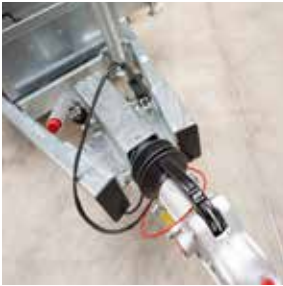
Rahmen aus geschweißtem Hohlprofil für Stabilität
