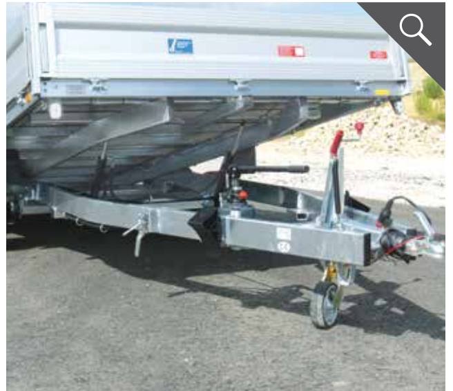
Verschweißter und feuerverzinkter Stahlrahmen
