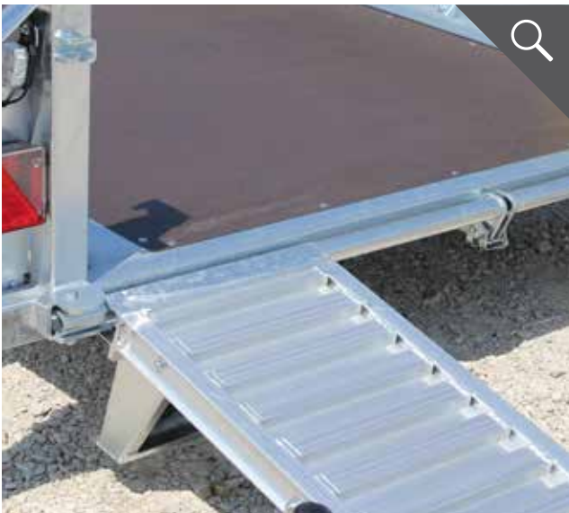
Auffahrrampen leicht zu verschieben für unterschiedliche Fahrzeugbreiten
