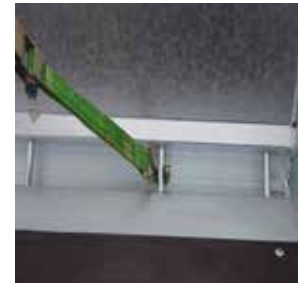
Zurrpunkte mit je 2.000 kg belastbar
