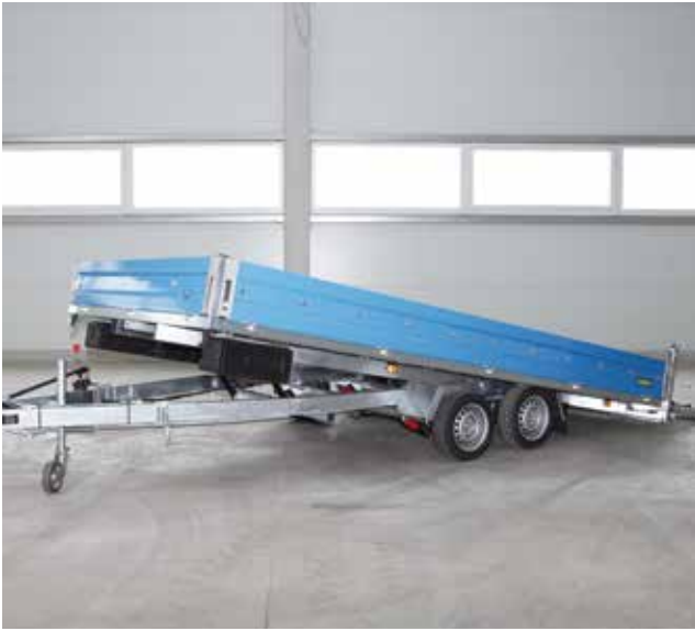
Pulverbeschichtete Bordwände Typ PKL
