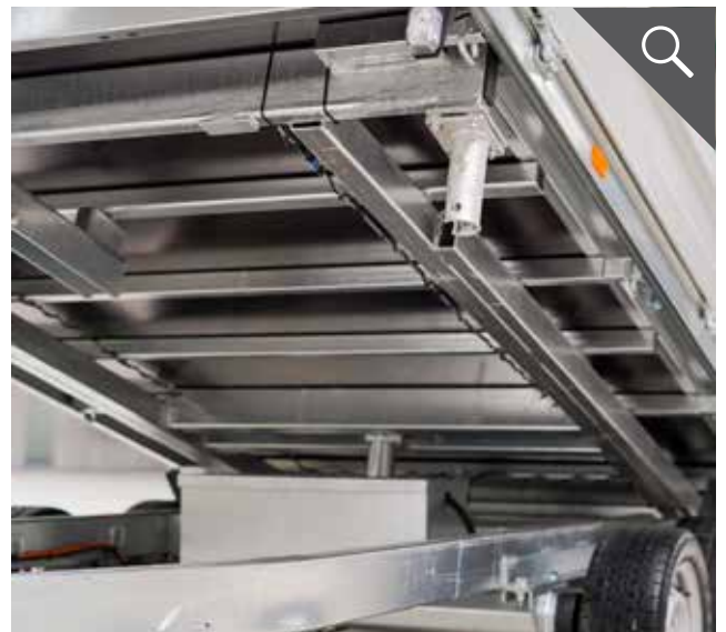
Verschweißter und feuerverzinkter Stahlrahmen
