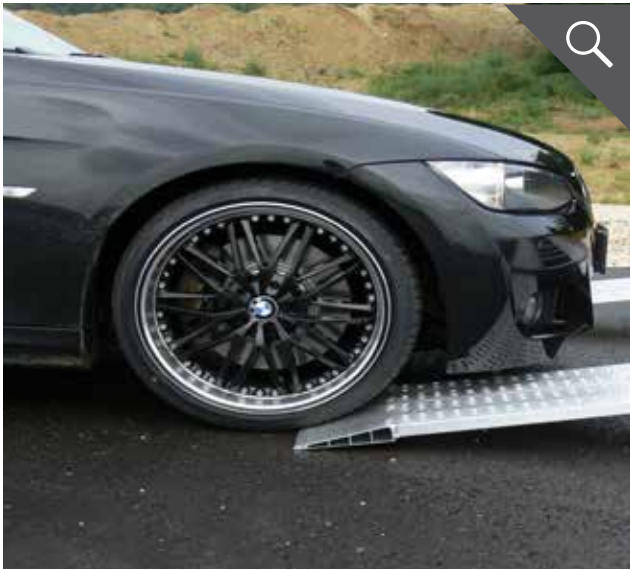
Geringer Auffahrwinkel an den Auffahrschienen 7°
