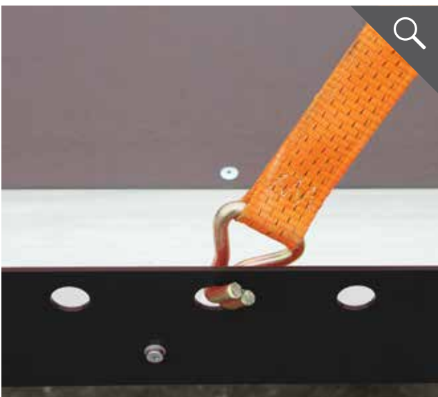
Zurpunkte in der Seitenreling mit 400 kg belastbar
