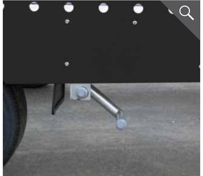
Quickstop-Fußbetätigung zum Entriegeln der Auffahrschienen
