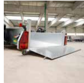
Flacher Auffahrwinkel mit 5°
