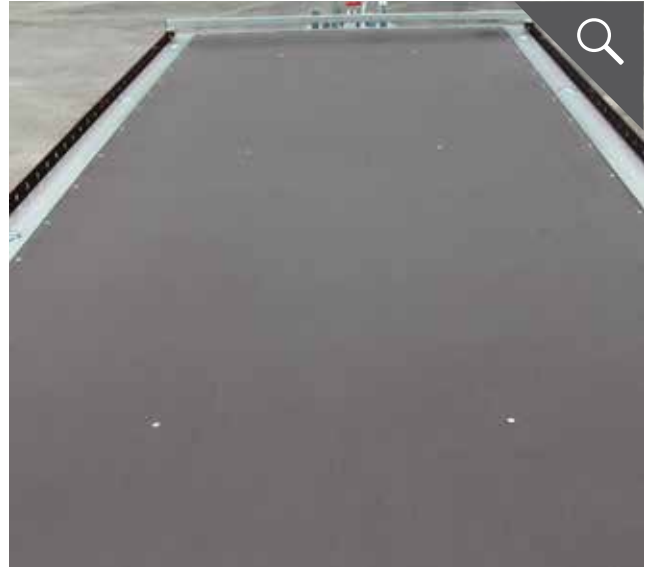
Durchgehende Bodenplatte ohne Stoß (18 mm)
