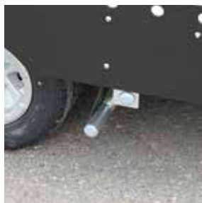
Einfache Entriegelung der Auffahrschienen durch Quickstop-Fußbetätigung
