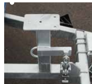
Windenbock für 900 kg Handseilwinde
