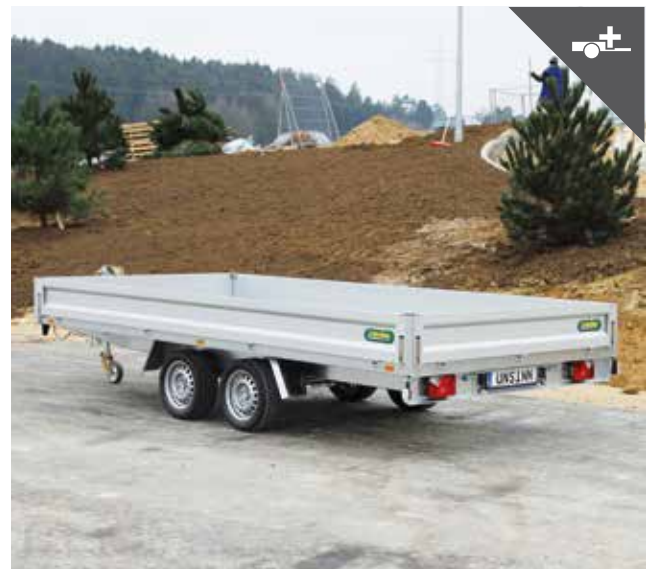
Grund-Bordwandsatz mit versenkten Verschlüssen
