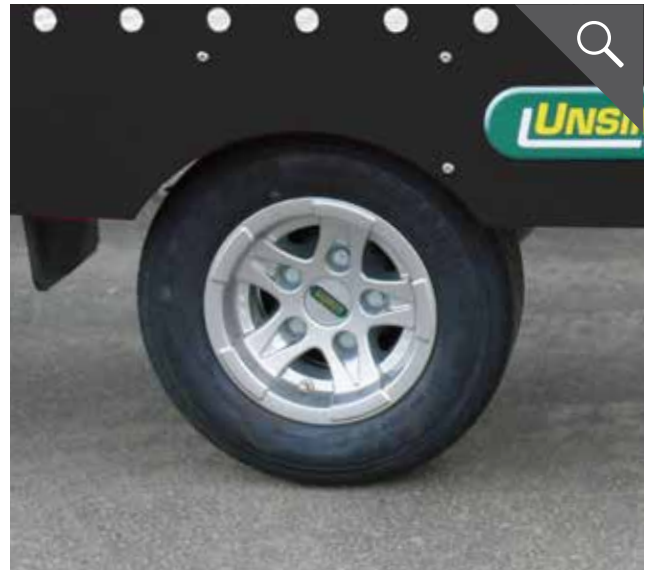
10 Zoll Bereifung für eine niedrige Ladehöhe
