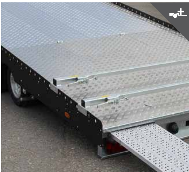
Radstopper für Fahrzeugbreite
