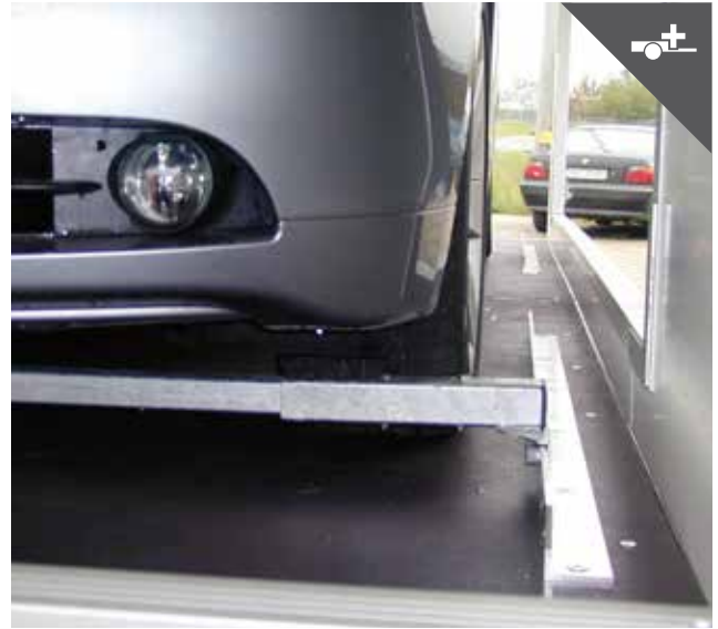
Radstopper für Fahrzeugbreite
