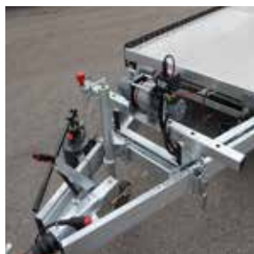
Verschweißter und feuerverzinkter Stahlrahmen
