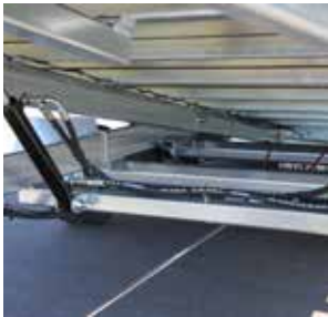
Ladefläche kippbar durch Schwerpunktverlagerung
