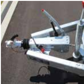
Rahmen aus geschweißtem Hohlprofil
