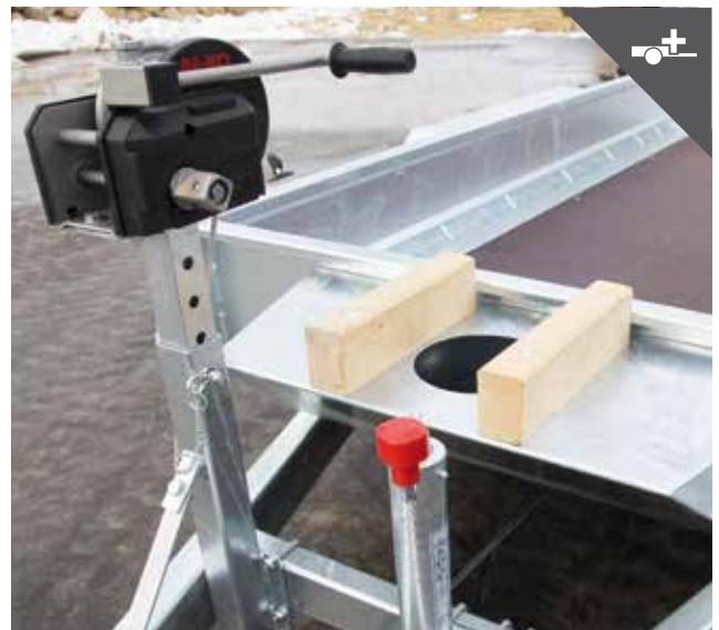
Baggerarmauflage, Windenbock mit Handseilwinde
