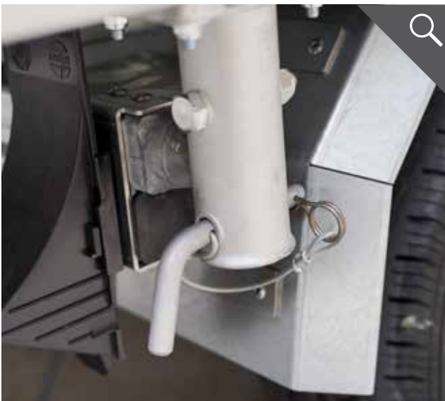
Umsteckbolzen für die Kippfunktion
