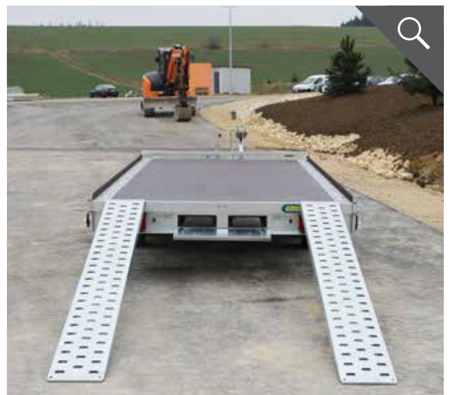
Auffahrtschienen mit 2400 kg Tragkraft
