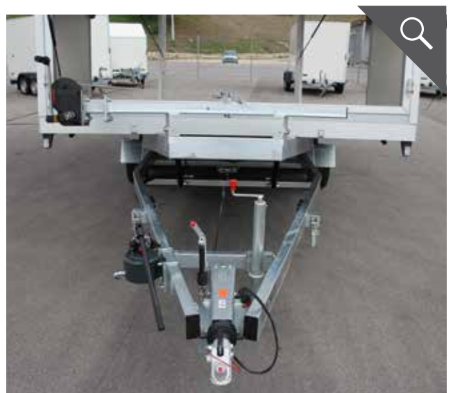
Fahrgestell aus verschweißter und feuerverzinkter Hohlprofilkonstruktion
