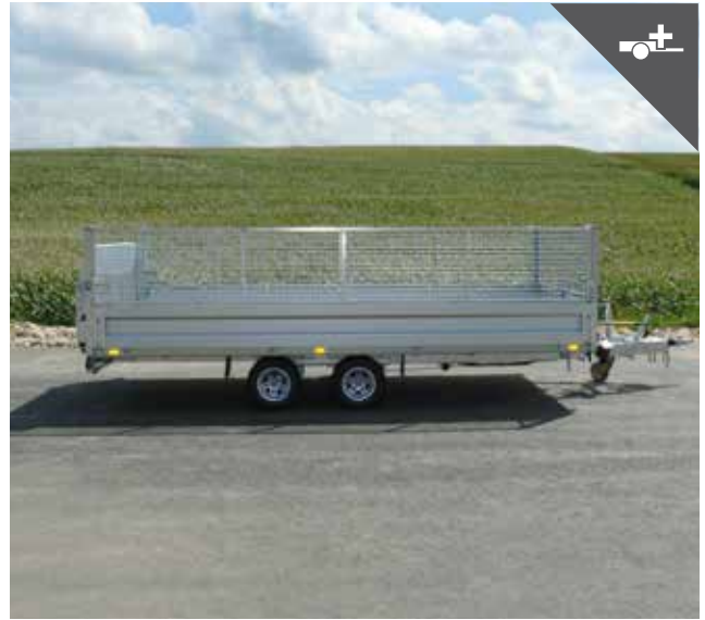
Welldrahtgitteraufsatz für mehr Ladevolumen
