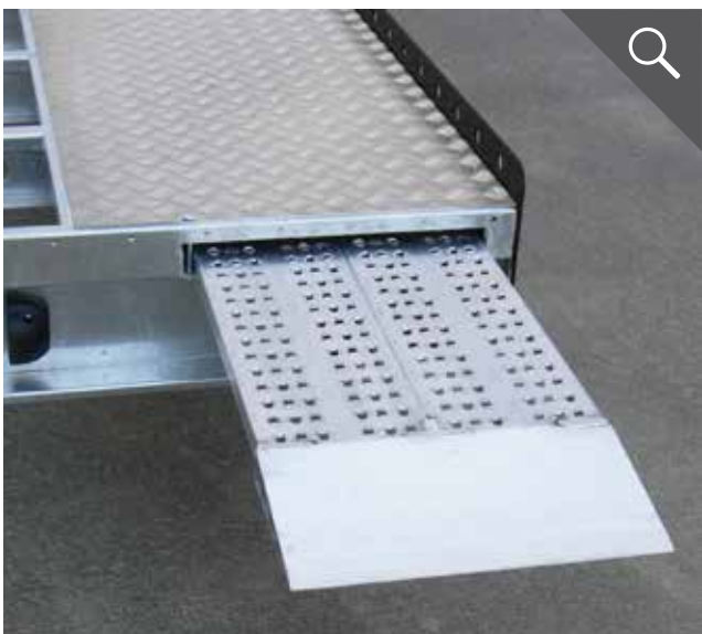
2 Alu-Auffahrschienen unter der Ladefläche, Entriegelung über die Quickstop-Fußbetätigung
