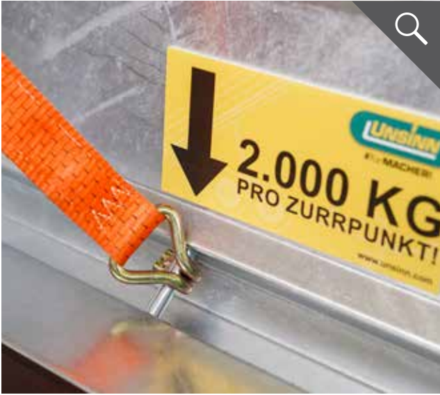
Zurripunkt fest im Rahmen mit 2000 kg Zugkraft
