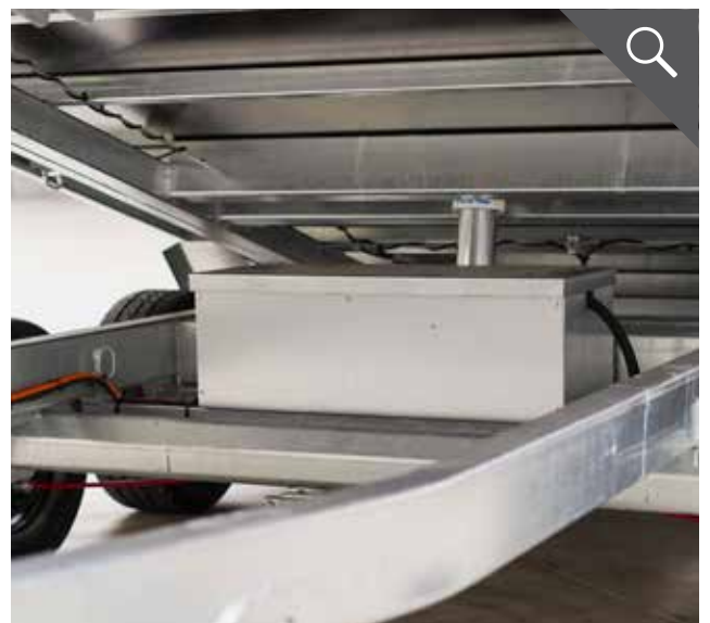
Elektrohydraulik mit Funkfernbedienung inkl. Batterie und Ladegerät
