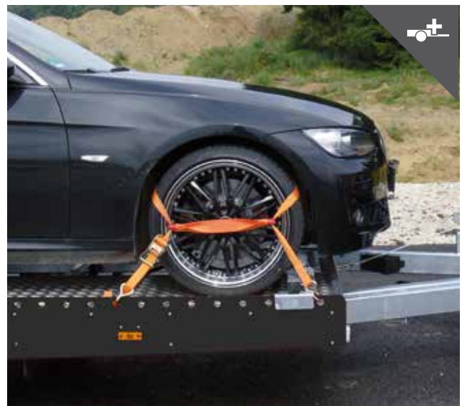
Flexible Verzurrmöglichkeiten der Radsicherungsgurte
