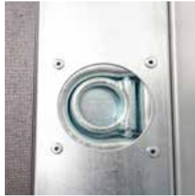
8 Zurrmulden versenkt im Bodenrahmenprofil Dekra zertifiziert
