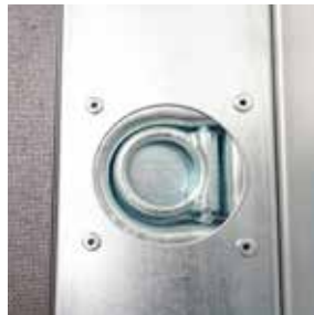
8 Zurrmulden versenkt im Bodenrahmenprofil Dekra zertifiziert
