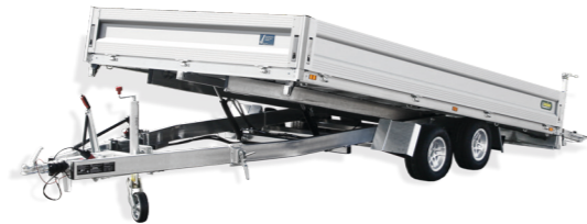
Pritschenhochlader kippbare Ladefläche Typ PKL 3042-10-2040 Kastenmaße innen: L/B/H 4260 x 2040 x 350 mm zGG*: 3000 kg Nutzlast: ca. 2190 kg Bereifung: 195/55 R10 AF
