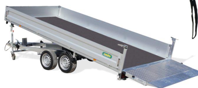
Maschinentransporter / Kipper Typ DUO 3542-13-2040 Windenbock, Elektrohydraulik, Funkfernbedienung Kastenmaße innen: L/B/H 4260 x 2040 x 350 mm zGG*: 3500 kg Nutzlast: ca. 2410 kg Bereifung: 195/50 R13C
