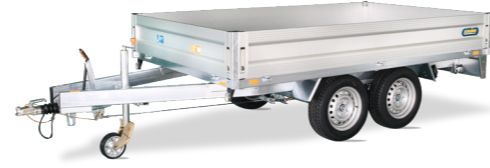
Pritschenhochlader Typ GTP 2636-14-1750 Kastenmaße innen: L/B/H 3660 x 1750 x 350 mm zGG*: 2600 kg Nutzlast: ca. 2070 kg Bereifung: 185/65 R14
