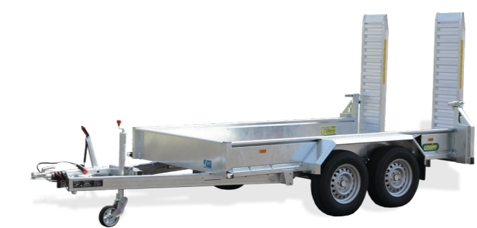
Baumaschinenanhänger Typ UBA 3030-14-1600 Kastenmaße innen: L/B/H 3060 x 1600 x 300 mm zGG*: 3000 kg Nutzlast: ca. 2380 kg Bereifung: 185 R14C 8PR
