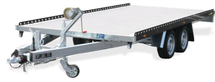
Universaltransporter Typ PU 3542-13-2040 Kastenmaße innen: L/B 4260 x 2040 mm zGG*: 3500 kg Nutzlast: ca. 2725 kg Bereifung: 195/50 R13C
