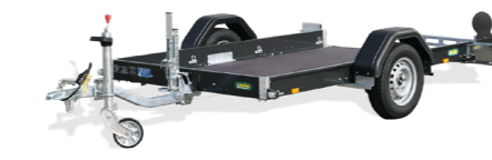
Absenkanhänger Typ AS 826-13-1550 Kastenmaße innen: L/B/H 2600 x 1550 x 150 mm zGG*: 750 kg Nutzlast: ca. 515 kg Bereifung: 175/70 R13
