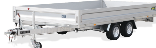
Pritschenhochlader Typ GTP 2642-10-2040 Kastenmaße innen: L/B/H 4260 x 2040 x 350 mm zGG*: 2600 kg Nutzlast: ca. 2030 kg Bereifung: 195/55 R10C AF
