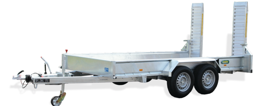
Baumaschinenanhänger Typ UBA 3536-14-1800 Kastenmaße innen: L/B/H 3660 x 1800 x 300 mm zGG*: 3500 kg Nutzlast: ca. 2730 kg Bereifung: 185 R14C 8PR
