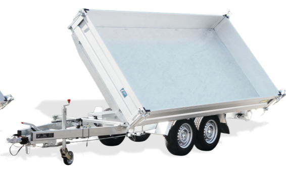
Dreiseitenkipper Typ UDK 3536-14-1750 Stahlboden und Winkelhebelverschlüsse, Elektro-Hydraulik, Nothandpumpe Kastenmaße innen: L/B/H 3660 x 1750 x 350 mm zGG*: 3500 kg Nutzlast: ca. 2630 kg Bereifung: 185 R14C 8PR
