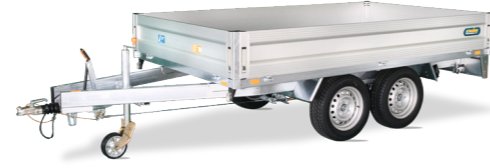
Pritschenhochlader Typ GTP 2630-14-1750 Kastenmaße innen: L/B/H 3060 x 1750 x 350 mm zGG*: 2600 kg Nutzlast: ca. 2100 kg Bereifung: 185/65 R14
