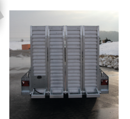
Baumaschinenanhänger Typ UBA 3536-14-1800 Kastenmaße innen: L/B/H 3660 x 1800 x 300 mm zGG*: 3500 kg Nutzlast: ca. 2730 kg Bereifung: 185 R14C 8PR
