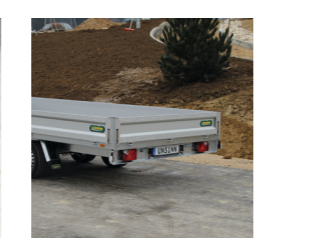
Pritschenhochlader kippbare Ladefläche Typ PKL 3042-10-2040 Kastenmaße innen: L/B/H 4260 x 2040 x 350 mm zGG*: 3000 kg Nutzlast: ca. 2190 kg Bereifung: 195/55 R10 AF
